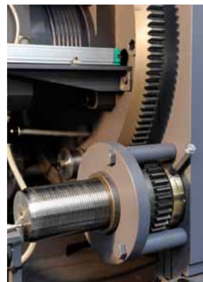
Particolare della corona centrale comandata da motoriduttore elettrico
