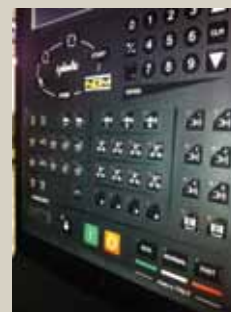
Pannello di controllo con i tre pulsanti "Eco", "Normal" e "Fast" del sistema autoadattativo
