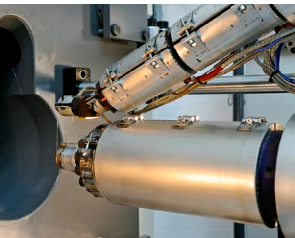
Particolare degli ugelli doppia iniezione
