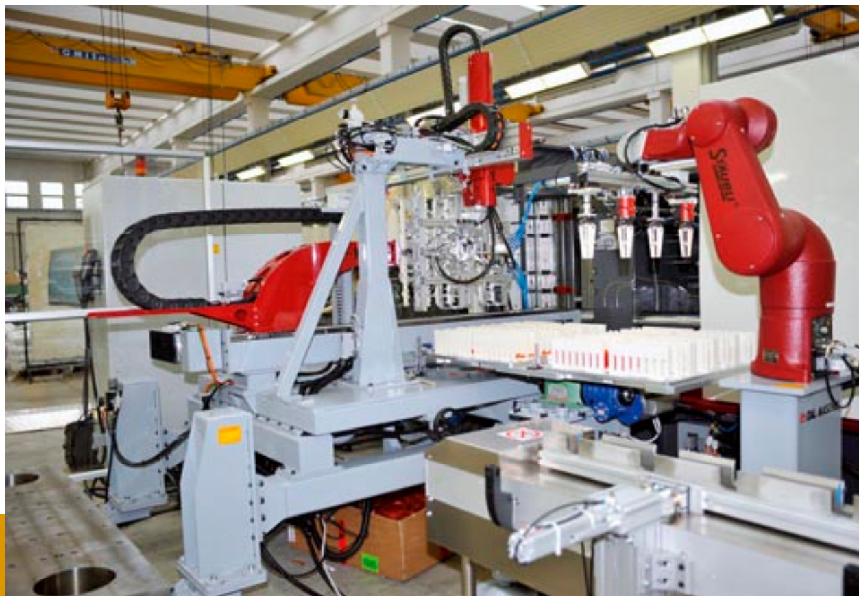
L'isola di stampaggio con pressa Plastic Metal e sistema di manipolazione Dal Maschio Group
