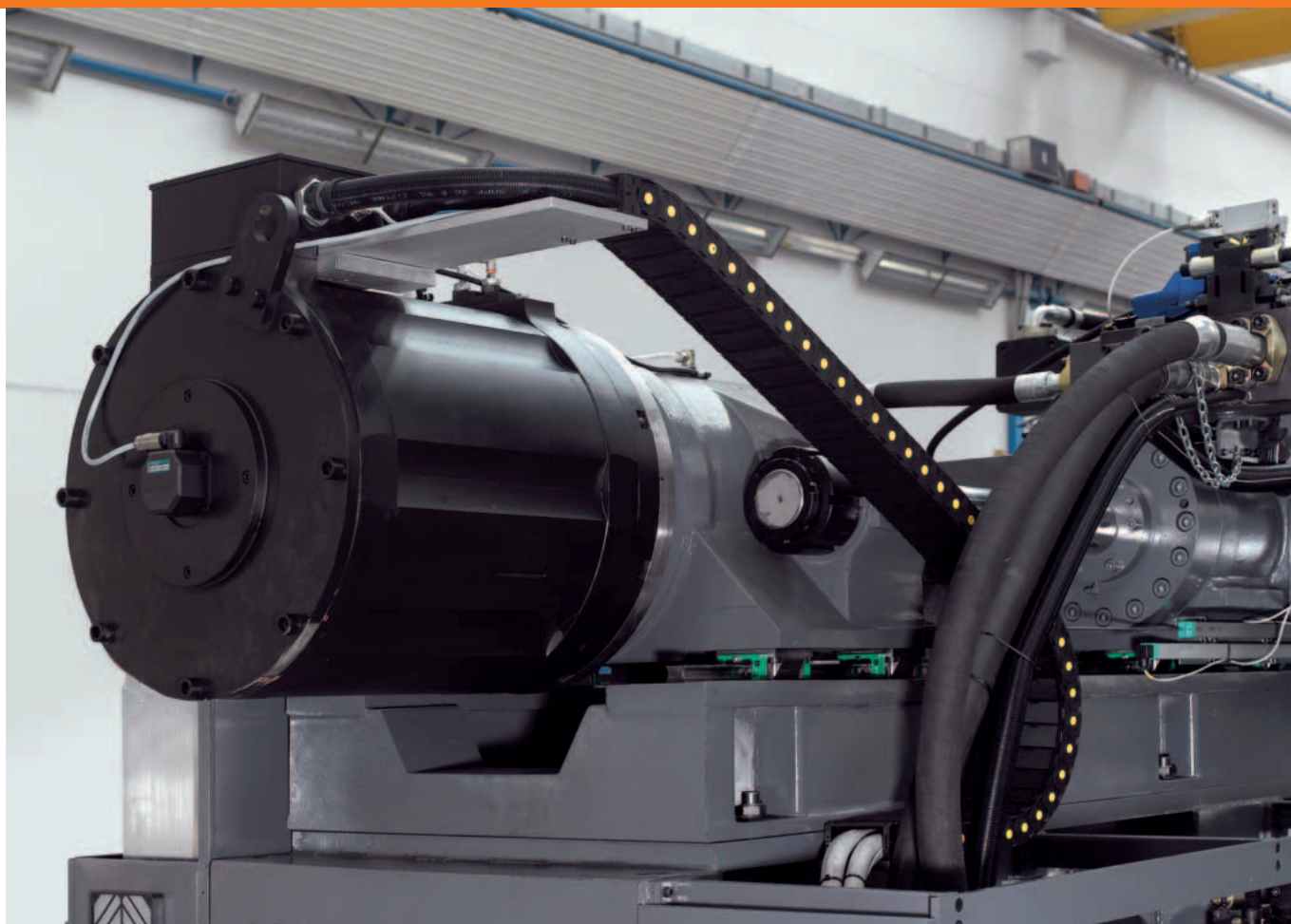
Applicazione speciale: motore "torque" sulla vite.
